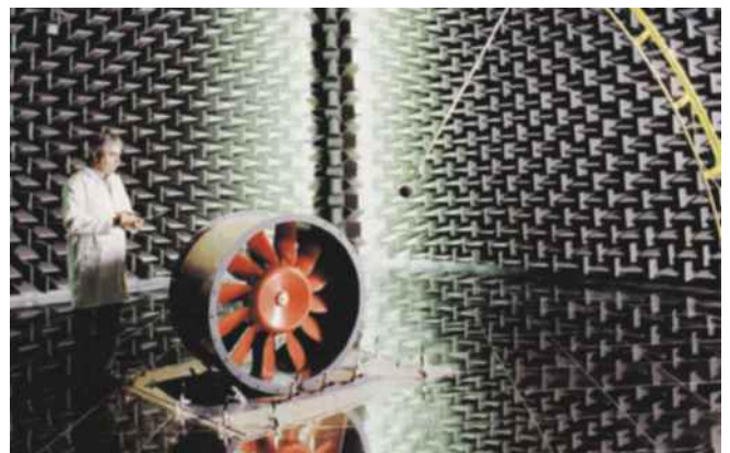
Cámara anecoica / Anechoic chamber
